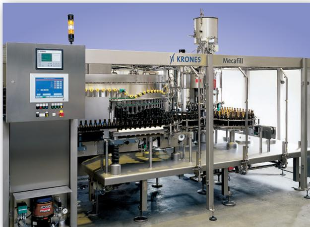
La gama de productos Werma incluye artículos con AS-Interface®. Todo el sistema electrónico de bus queda integrado en el componente colocado en la base de la columna luminosa. Sobre este pueden instalarse hasta 3 componentes luminosos y 1 acústico o, en su caso, pueden combinarse y accionarse individualmente 4 componentes luminosos.
